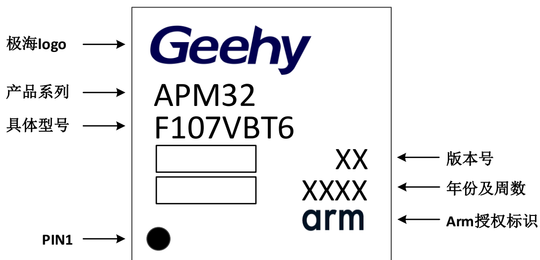
图 16 LQFP100 - 100 引脚, 14 x 14mm 封装标识
